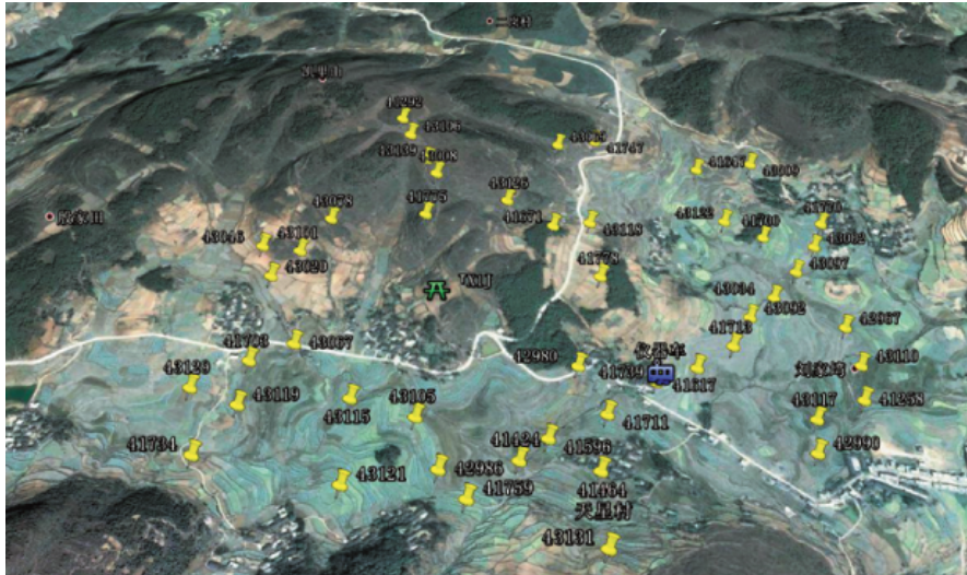
图 1.5 用于垂直井水力压裂微地震监测的面稀疏台网观测系统 (马天翔, 2019)。
